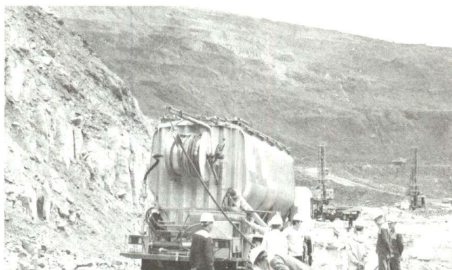
Hình 3. Sử dụng máy quay camera tốc độ cao để giám sát vụ nổ và áp dụng cơ giới hóa nạp mìn trên các mỏ than lộ thiên – TKV
