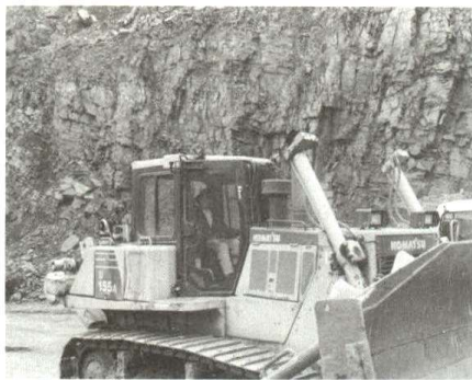
Hình 2. Máy gạt CAT D155A và Máy khoan xoay cầu CAT MD6250 trên mỏ than lộ thiên-TKV - Các loại máy ủi có công suất 180÷300 cv như D-8N, D-9N, D-10R (Caterpillar), T-170 (Nga), D-85A (Komatsu) được dùng để thải đá trên bãi thải hoặc làm tơi sơ bộ đất đá khi lấp thêm răng xới
